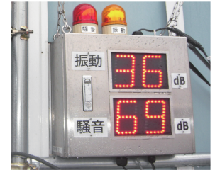
コンクリートの取壊し作業 ヤード内騒音、振動値表示
